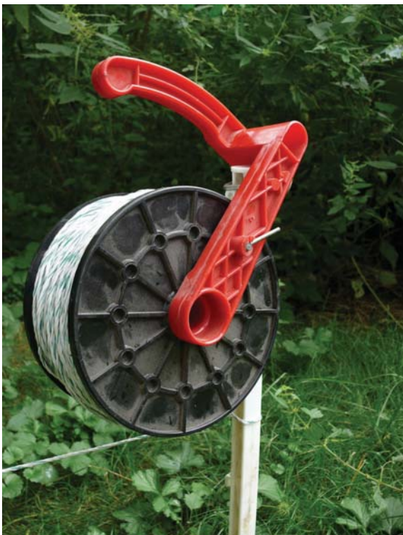
Abb. 9. Haspel mit Litze an Endpfahl des Zaunes eingehängt.
